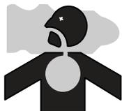
Überprüfen Sie die Abluftrohre und Rohrverbindungen auf Gasleckagen. Die Abgase aus dem Motor enthalten Kohlenmonoxid und andere schädliche Stoffe. Der Betrieb des Motors in einem schlecht belüfteten Bereich kann zu einer Gasvergiftung führen.
