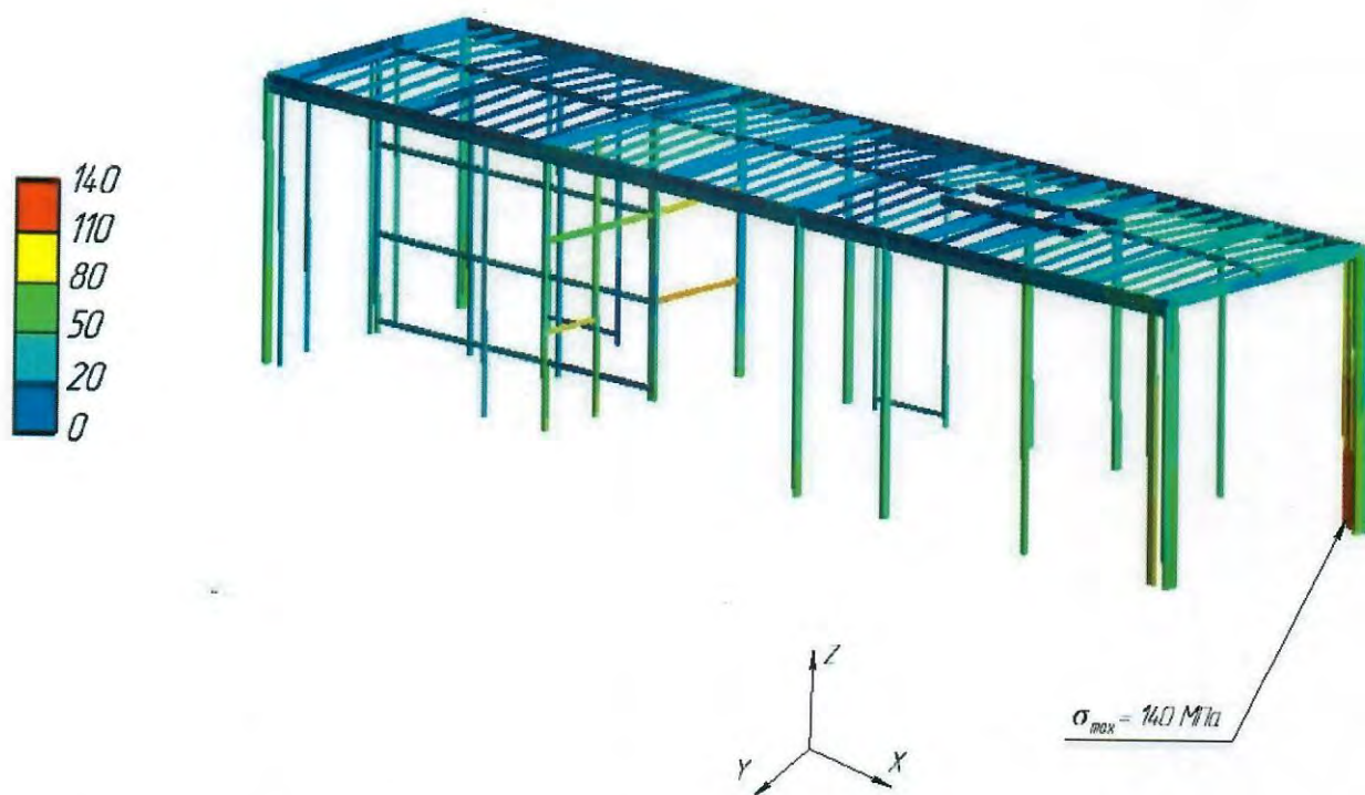
Рисунок 5.27 – Распределение напряжений категории (\sigma_s)_2 в каркасе и крыше контейнера от нагрузок НЭ+МРЗ
