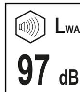
Уровень шума по шкале "А" генератора в месте эксплуатации имеет показатели выше 70 дБ(А). Данный показатель указан на табличке в виде двузначного числа на основании результатов испытаний корпуса генератора в соответствии со стандартом EN ISO 4857:2009.
