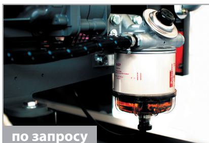
Топливный фильтр-водоотделитель с автоматическим отключения электростанции при наличии воды в топливной системе
