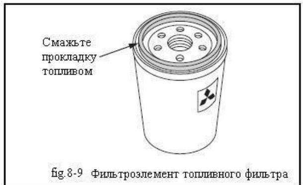
fig 8-9 Фильтроэлемент топливного фильтра
