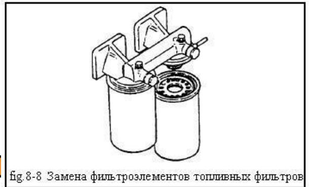
fig 8-8 Замена фильтроэлементов топливных фильтров
