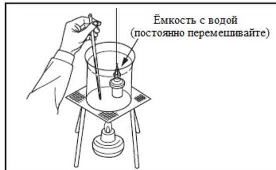
Для термостата(элемента) маслосистемы: температура начала открытия  $80 \dots 84^\circ\text{C}$ , температура полного открытия  $95^\circ\text{C}$ , высота подъема термостата не менее 11 мм.
