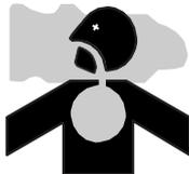
Не допускайте работы двигателя внутри закрытых помещений (внутри складов, туннелей и т.д.) или там, где все его стороны закрыты, так как выхлопные газы могут вызвать отравление ими.
