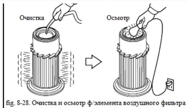
fig. 8-28. Очистка и осмотр ф/элемента воздушного фильтра
