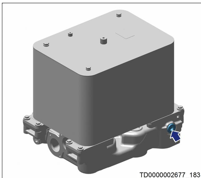
Иллюстрация 134: Отбор пробы моторного масла
