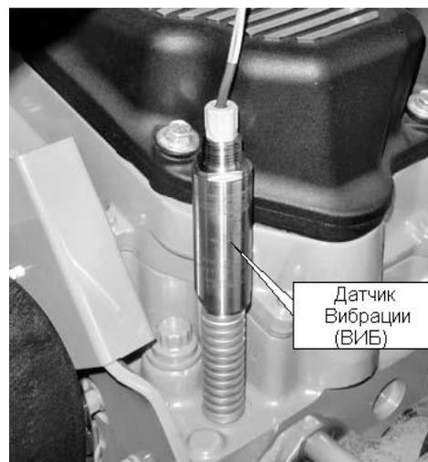
По возможности, датчик ВИБ следует монтировать вертикально (в той же плоскости, что и цилиндры двигателя). При использовании только одного датчика ВИБ монтируйте его на любом краю двигателя. При использовании двух датчиков ВИБ, монструйте датчики на противоположных краях двигателя (по диагонали). **Прим: Датчики вибрации включены в состав комплектов Серии III и Серии IV. Они также рекомендованы, но поставляются только по отдельному заказу для комплектов Серии А, Серии I и Серии II.**
