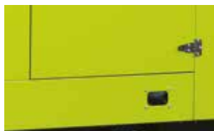
Отверстия для топливных трубопроводов
