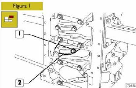
Svitare le viti di fissaggio (1) e rimuovere i cappelli di biella (2). Sfilare gli stantuffi completi di bielle dalla parte superiore del basamento.
