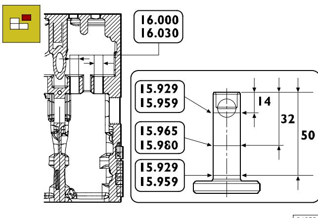
MAIN DATA CONCERNING THE TAPPETS AND THE RELEVANT HOUSINGS ON THE ENGINE BLOCK
