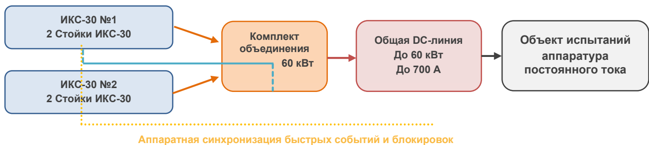
Рисунок 3 — Системная конфигурация линии до 60 кВт из двух комплектов ИКС-30.
