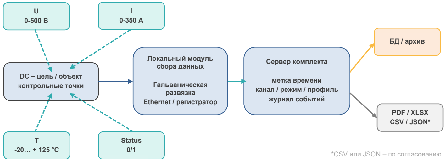
Рисунок 7 — Двухуровневая измерительная система: встроенный контроль и удаленные контрольные точки.
